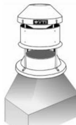
Etape 5 : fixation de l'extracteur sur le cône béton
