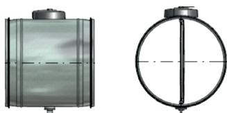
Registre de dosage circulaire en acier galvanisé et joint à lèvres. Permet le réglage du débit d'air. En ventilation mécanique autoréglable il peut être nécessaire de prévoir un registre d'équilibrage par ouïe de sortie du plénum.
