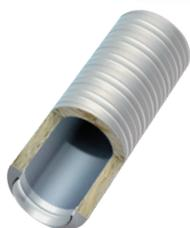
Les silencieux circulaires permettent de piéger le son et de réduire les nuisances sonores des systèmes de ventilation. Les silencieux présentent une perte de charge négligeable et ne perturbent aucunement le flux d'air.
