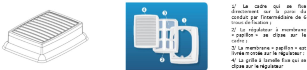
Figure 2 – Bouches d'extraction OCEANE – Visuel et éclaté
