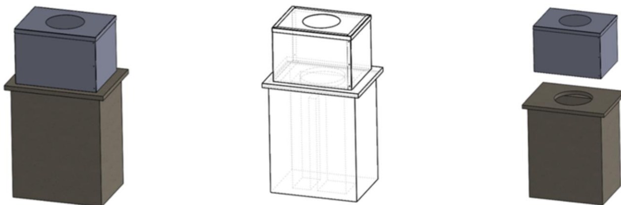
Figure 9 – Schéma de principe d'un plénum de recouvrement en applique sur dalle existante conservée
