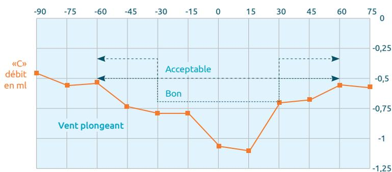
Orientation du vent (en °) - Facteur «C» selon les inclinaisons du vent sur l'extraiteur
