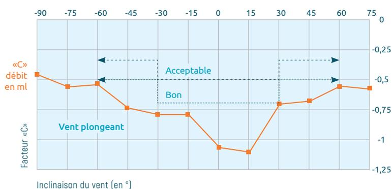
EXTRACT'OR est un extracteur statique anti-refouleur, antisiphon, norme P 50-413 qui conserve ses performances aérodynamiques quels que soient les angles, les azimuts et la force des vents.
